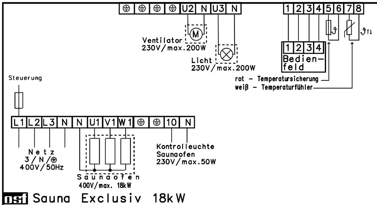
Die elektronische Steuerung ist durch eine 0,16A-Feinsicherung auf der Leiterplatte abgesichert. Die angeschlossenen einphasigen Verbraucher sind durch einen 16A-Sicherungsautomaten abgesichert. Der Saunaofen ist nicht gegen Kurzschluß abgesichert. Der Kurzschlußschutz ist durch geeignete bauseitige Sicherungen (max. 32A) zu gewährleisten. Falls ein Saunaofen mit mehreren Zuleitungen verwendet wird, sind diese am Ausgang der Steuerung ihrem Querschnitt entsprechend bauseits getrennt abzusichern.
